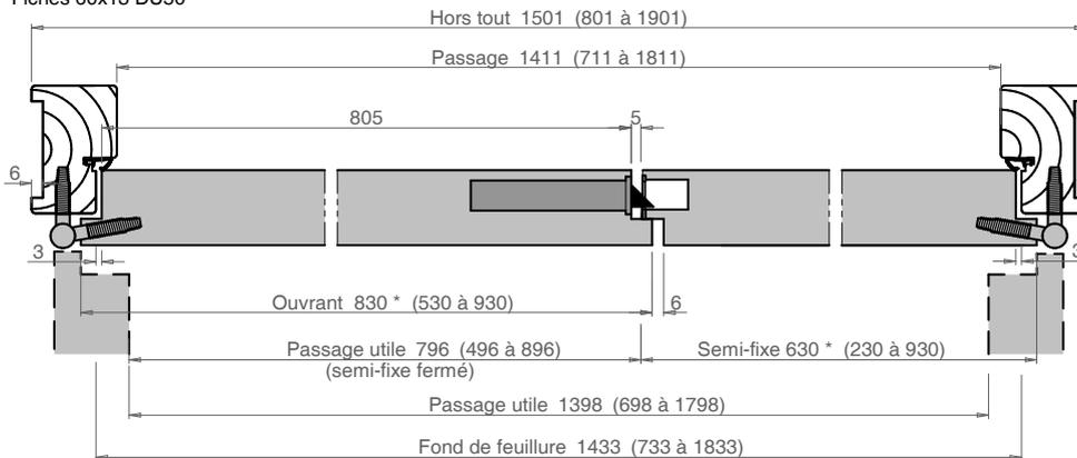
\* largeur ouvrant et semi-fixe fabriqués = largeur théorique - 3 mm
