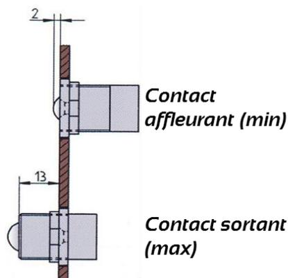
Figure 11 - Course du contact de position de sécurité
