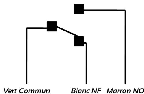
Figure 9 - Contact appuyé : Porte fermée
