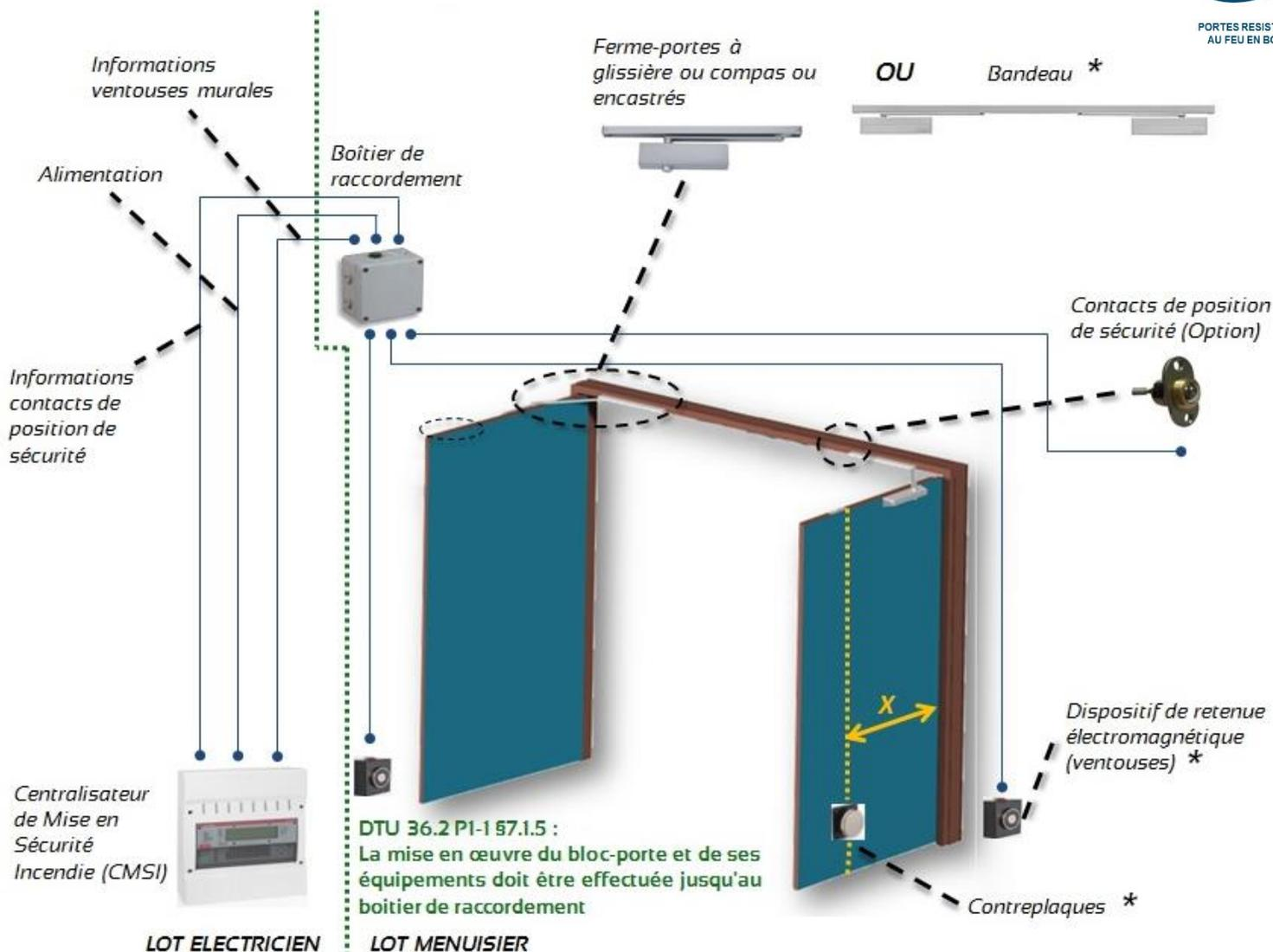
Figure 1 - Schéma de principe du bloc-porte DAS
