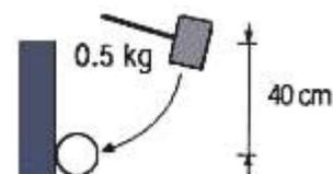
Figure 2 - Equivalence câble de degré IK07
